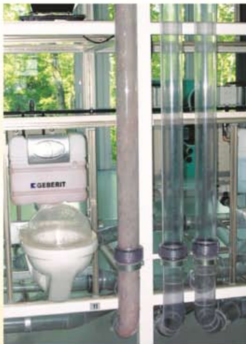
瑞士GEBERIT潔具廠實驗－排水壓縮試驗
